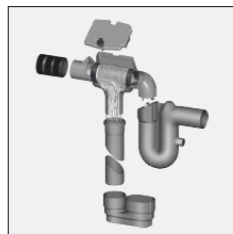
Filter-Ausbaupaket 2 Selbstreinigender Filter mit Edelstahl-Filtereinsatz, Maschenweite 0,35 mm, über 95% Wasseraus- beute, inklusive beruhig- tem Zulauftopf und Überlaufsiphon, Montage ohne Werkzeuge Best.-Nr. 295903
